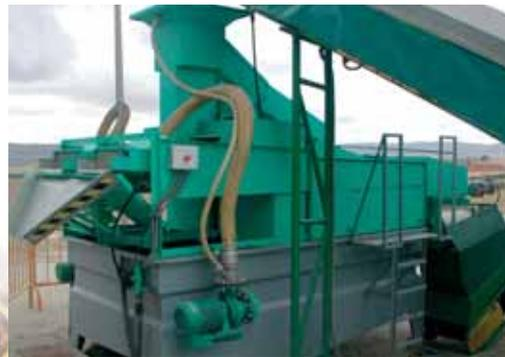
La aceituna del suelo, y ocasionalmente también la del árbol, contiene otro tipo de impurezas como tierra, barro, piedras, etc. cuya separación es necesaria porque provocan desgastes excesivos en la maquinaria (e incluso roturas), disminuyen el rendimiento industrial obtenido y comunican al aceite sabor a tierra, moho, etc. Su eliminación se hace mediante lavadoras de agua, basadas en la mayor densidad de estas impurezas.
