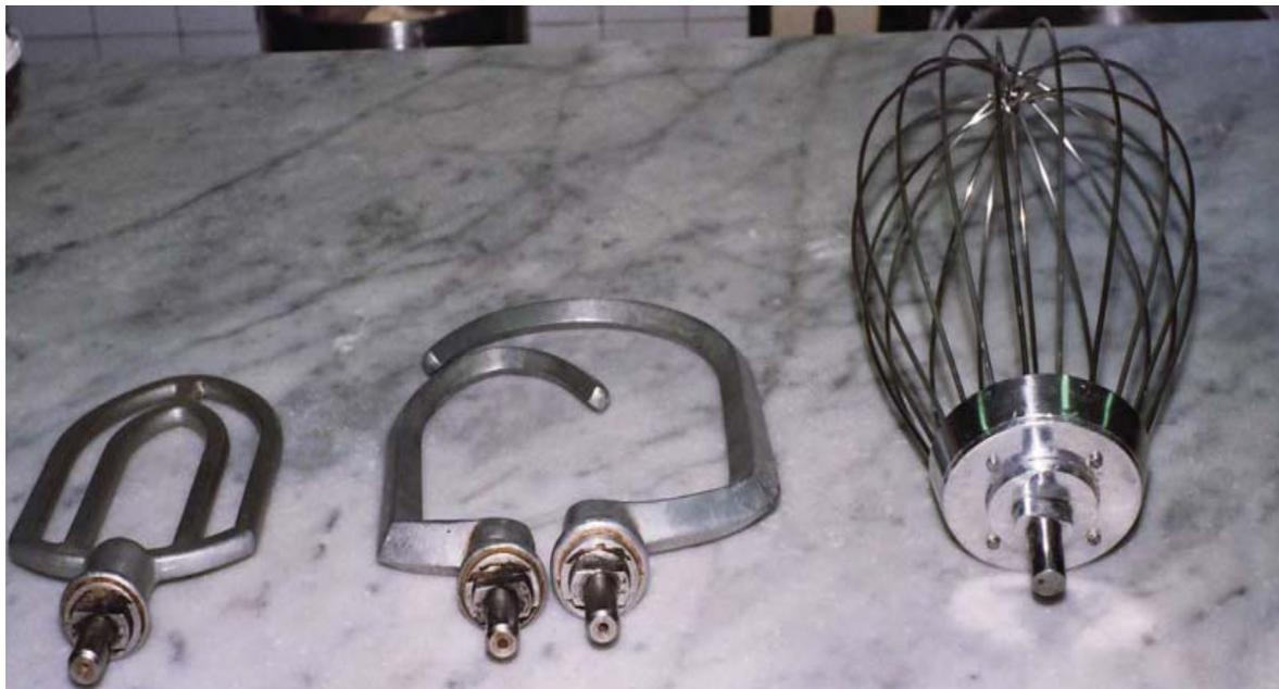
Fotografía 3.3: Elementos empleados para mezclar, amasar y batir.
