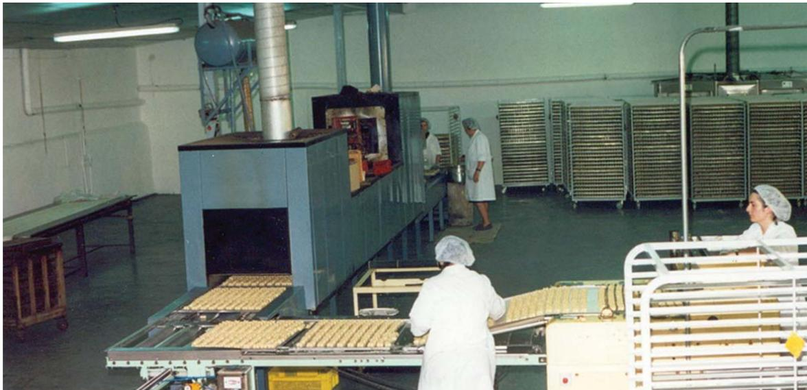
Fotografía 3.4: Obrador Industrial con horneado continuo.
