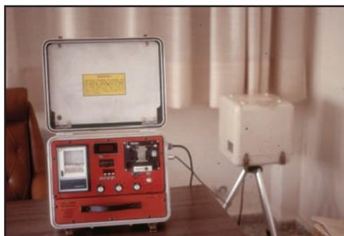
Figura 15.18. Cámara de ionización
